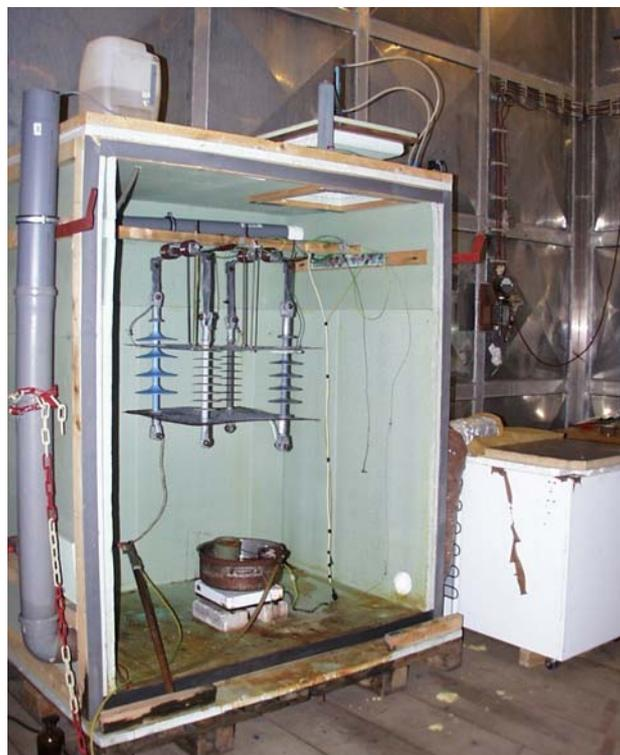
**Bild 5** Isolierte Prüfzelle für Btauungsversuche mit Prüflingen und Wasserbehälter
