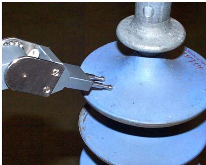
**Bild 21** Beispiel für die Messung der Schichtleitfähigkeit
